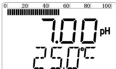
此时按住“▲”键 5 秒以上然后松开，即进入标定，显示第一点标定状态：此时把 pH 电极用纯净水冲洗干净，并用滤纸轻轻吸干，放入任意一种标准液中。这时系统会根据所测量的 mV 值自动识别标准溶液，并做好相应的温度补偿在上半屏显示出标液的 pH 值。下半屏有 STEP 1 标志。此时界面会交替显示如下：
